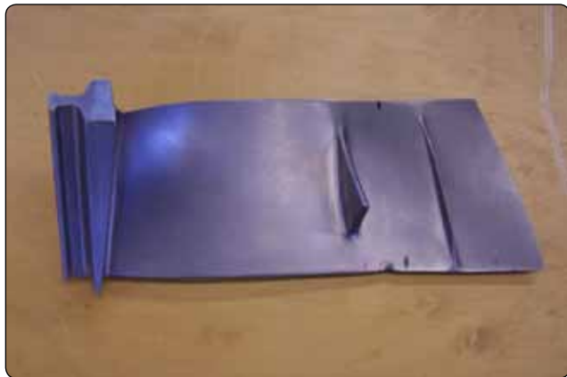
Figure 10-59. Fan blade damage.
